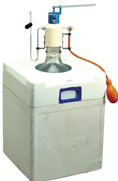
Un grand récipient rempli d'air à une pression un peu supérieure à la pression atmosphérique est ouvert pendant un court instant. Le gaz se détend jusqu'à la pression atmosphérique en une détente pratiquement adiabatique et il se refroidit. Puis, le gaz se réchauffe jusqu'à la température initiale (température ambiante) et la pression augmente.
