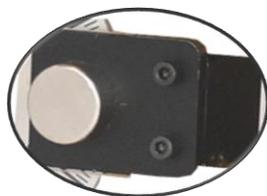
Le frein à frottement fluide est composé d'un ensemble aimant permanent très puissant et d'un électroaimant monté sur chariot. Cet ensemble est amovible transversalement par système à crémaillère actionné par un bouton moleté.
